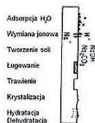
Rys. 2. Schemat wietrzenia szkła wskutek oddziaływania atmosfery
