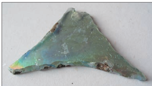
Fot. 31. Element łączący gomółki, tzw. „kącik”.
