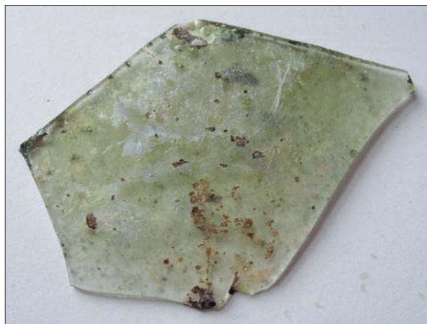
Fot. 8. Próbką nr 1 przed usunięciem powierzchni skorodowanej.
