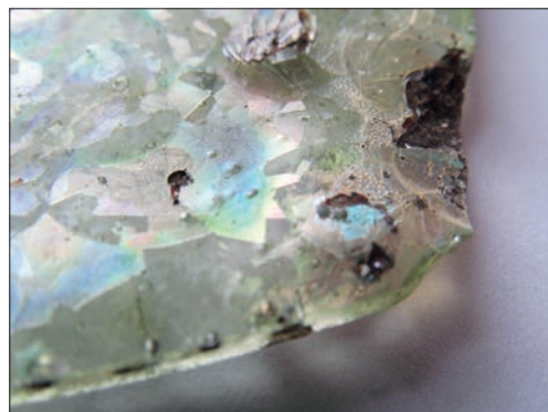
Fot. 7. Iryzacja na powierzchni gomółki.
